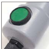
Schwingsäge und Sauggerät werden gemeinsam durch den grünen Starttaster der Säge eingeschaltet. Nach Abschaltung der Säge läuft der Sauger 5 Sekunden weiter, um Saughaube und Schlauch zu entleeren
